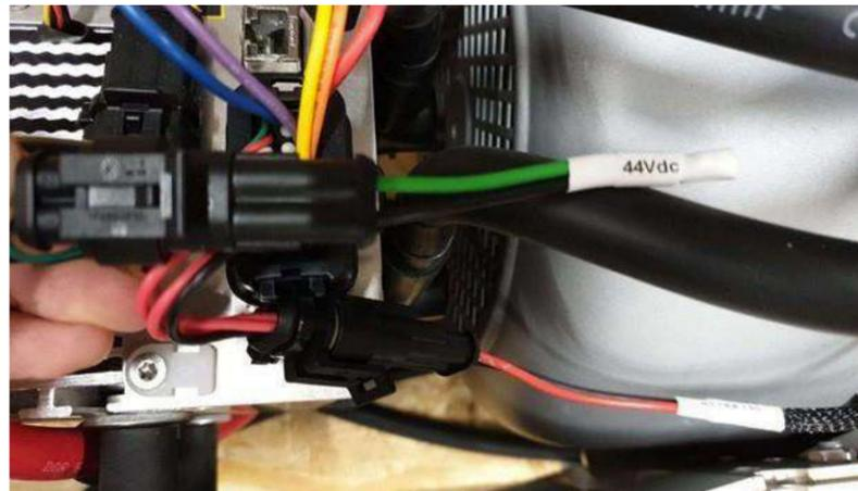
2. Si le câble vert/noir est connecté, la tension de "coupure", la tension minimale en dessous de laquelle le régulateur cesse de fonctionner, a été réduite à 37V.
